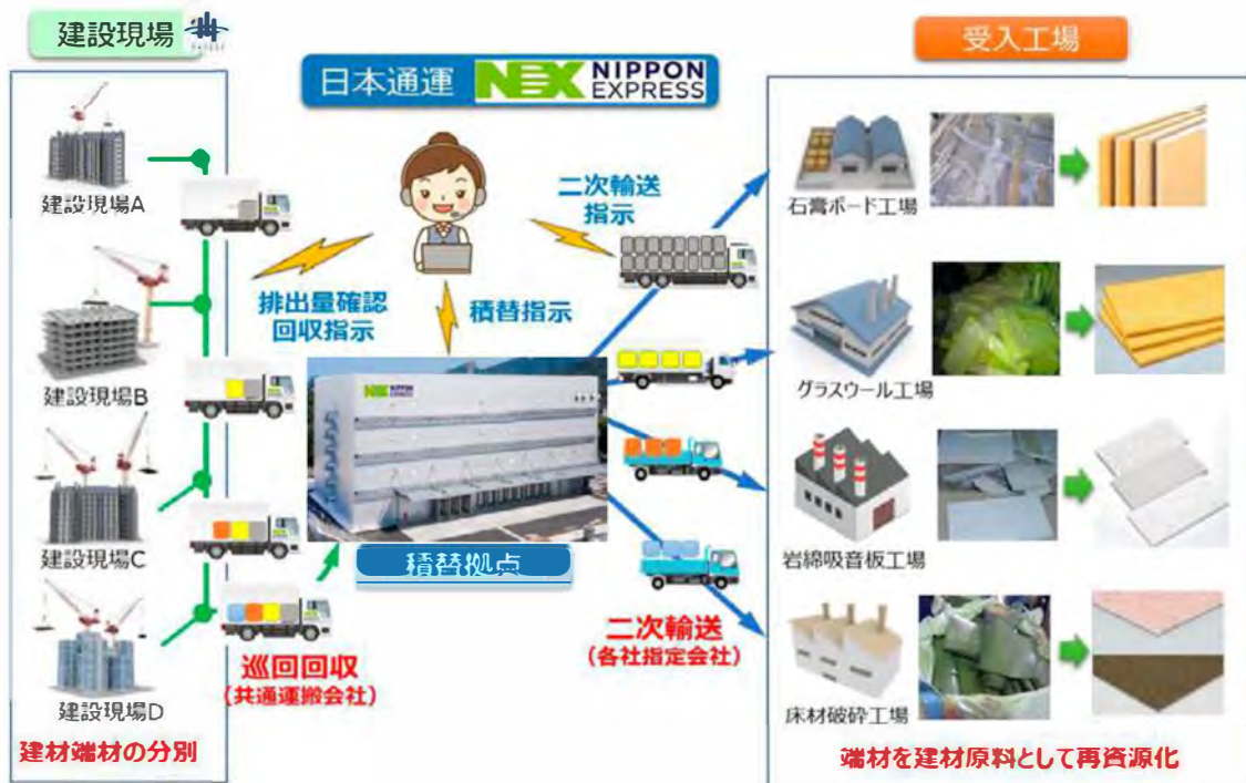
巡回回収システム概要図
