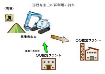
およびその近郊にある民間企業の建設発生土リサイクルプラントを福岡市によるリサイクルプラントとして認定し、 製造された砂を市の事業で使用することで新材砂の使用量を抑制するとともに建設発生土の再利用を実施している。
