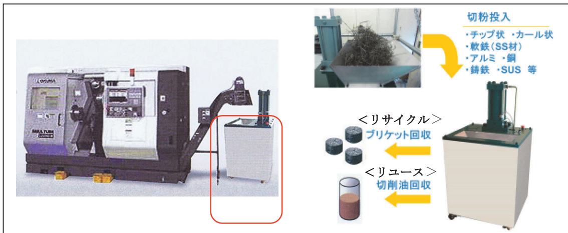
図2 本装置（赤枠）を工作機械の切粉出口に設置した例
