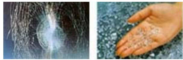
左:割れたときの合わせガラス 右:割れたときの強化ガラス
