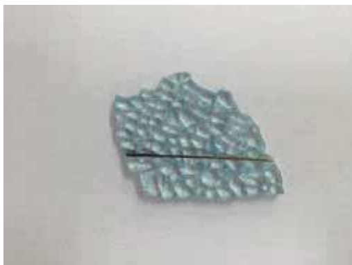
①剥離処理まえ(熱線有)
