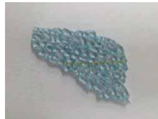
③剥離処理あと(熱線・糊剥離)
