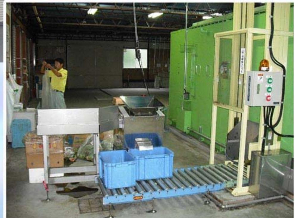
運ばれてきた食品残さは、シールやつまようじ等が混在していないか確認しながら破砕機に投入していきます。
