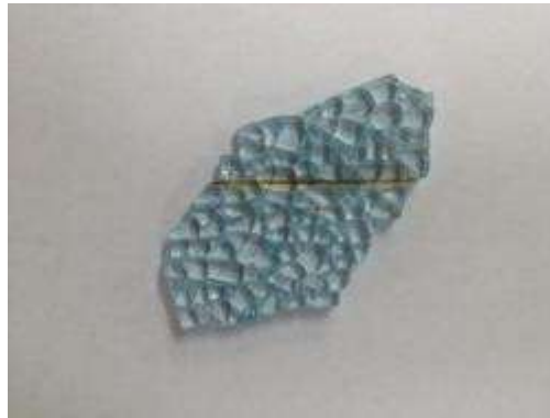
②剥離処理あと(熱線剥離)
