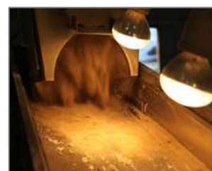
スラリーにて攪拌し、スプレッドライヤーにて噴霧乾燥
