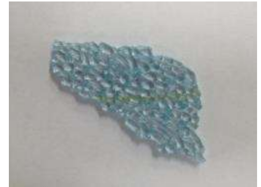
③剥離処理あと(熱線・糊剥離)
