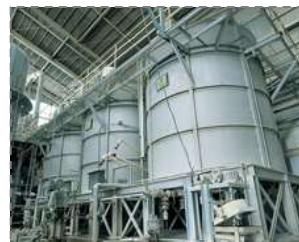
スラリーにて攪拌し、スプレッドライヤーにて噴霧乾燥
