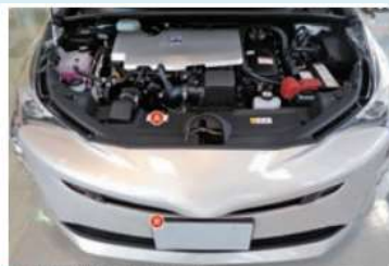
① ラジエーターサポートオープニングカバー ② フロントバンパーエクステンションマウンティング 自動車エンジンルーム部品 写真提供：いその(株)
