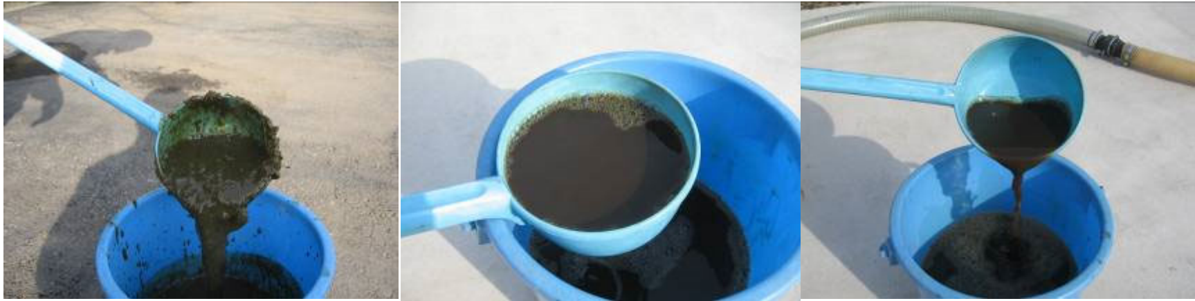
スラリーセパレータにより敷料等の夾雑物を除去
