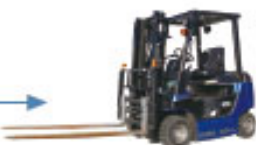
燃料電池（FC）フォークリフト フォークリフトに水素を利用し、環境保全センター内でカードルや農作物を運搬します。
