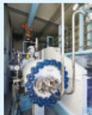
① 水素圧縮機 水素を82MPaまで圧縮します。
