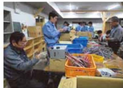
写真3 廃電線リサイクル作業
