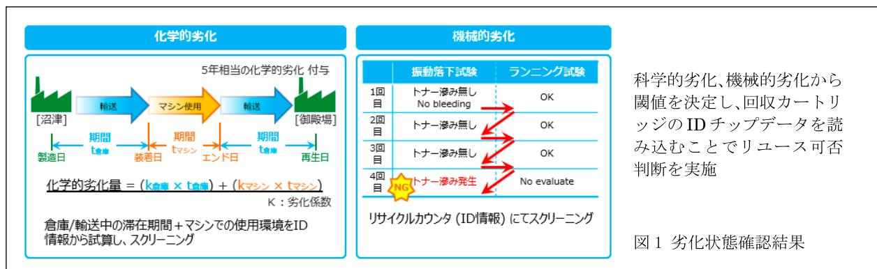
科学的劣化、機械的劣化から閾値を決定し、回収カートリッジのIDチップデータを読み込むことでリユース可否判断を実施
