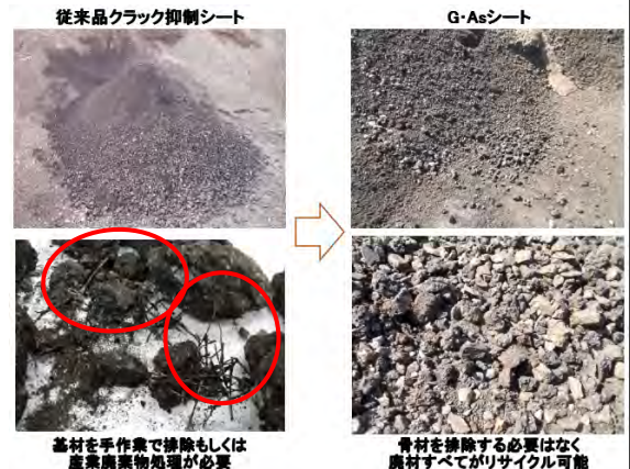
図-2 再生骨材製造状況
