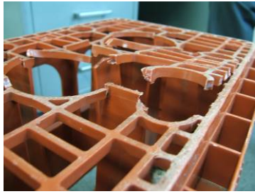
破損した P 箱(写真は底部破損)
