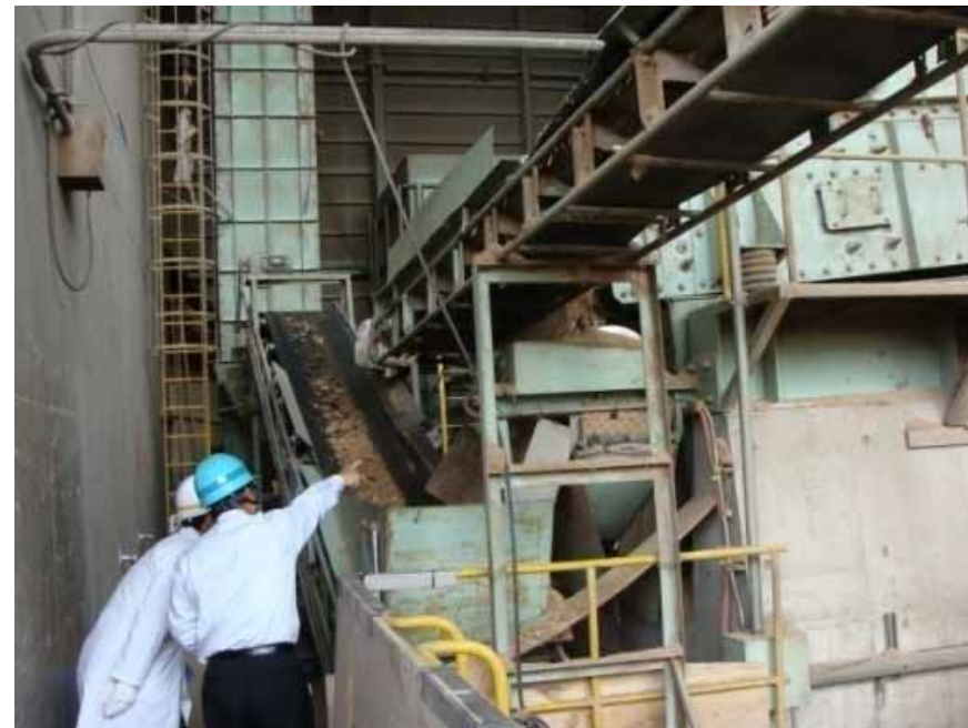
機械による選別 (風力や振動により選別される)
