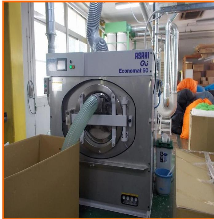
羽毛洗浄用の専用洗濯機で羽毛を洗浄します
