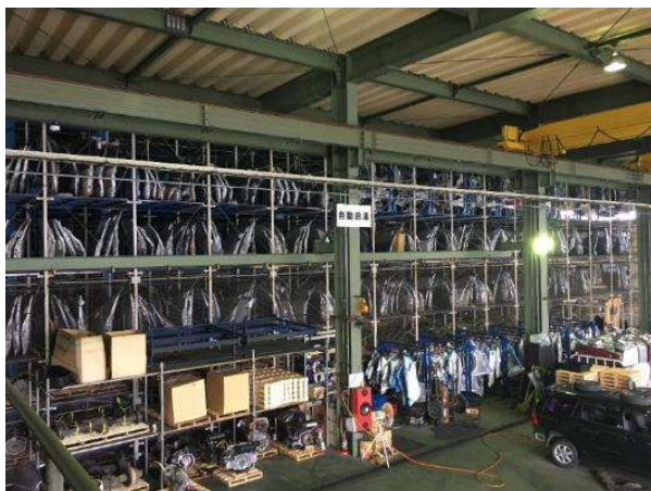
国内向け部品庫(自動倉庫)
