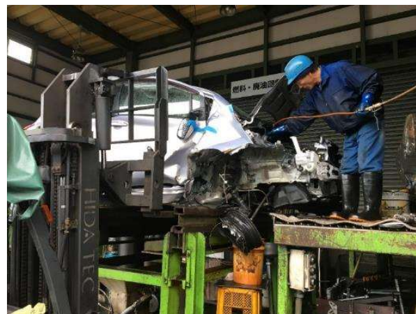
ガソリン・軽油・廃油・LLC抜き取り作業
