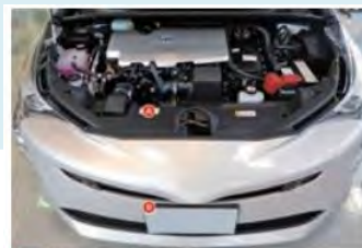
① ラジエーターボートオープニングカバー ② フロントバンパーエクステンションマウンティング 自動車エンジンルーム部品 写真提供：いその(株)
