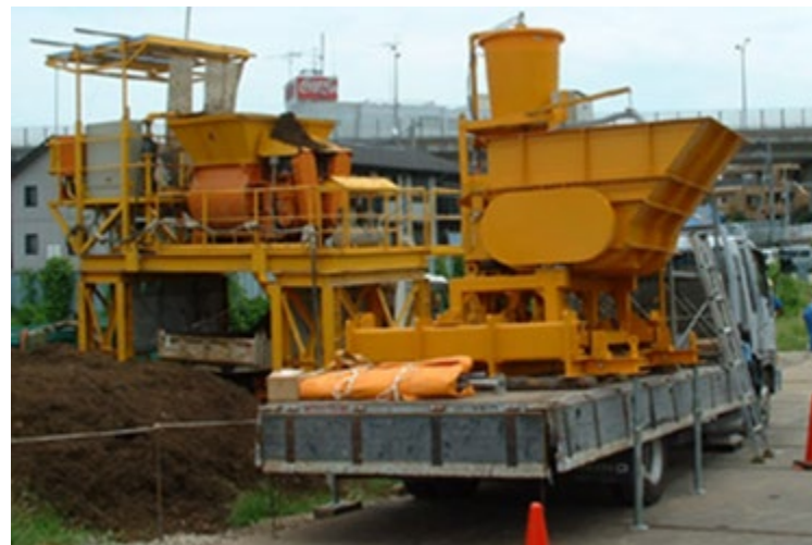
車載式小型プラント 4 t 車1台で搬入
