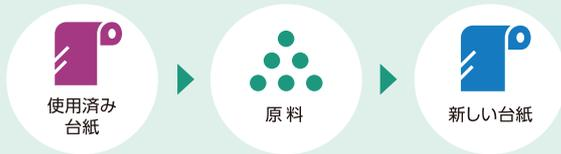
「剥離紙」をマテリアルリサイクル※2可能な素材で設計された「リサイクル専用台紙」に置き換えれば、使用済みのラベル台紙をユーザー様から有償回収できます。マテリアルリサイクルした回収材料を、再び「リサイクル専用台紙」の原料に使用することで、資源として循環する「水平リサイクル」スキームが確立しています。
