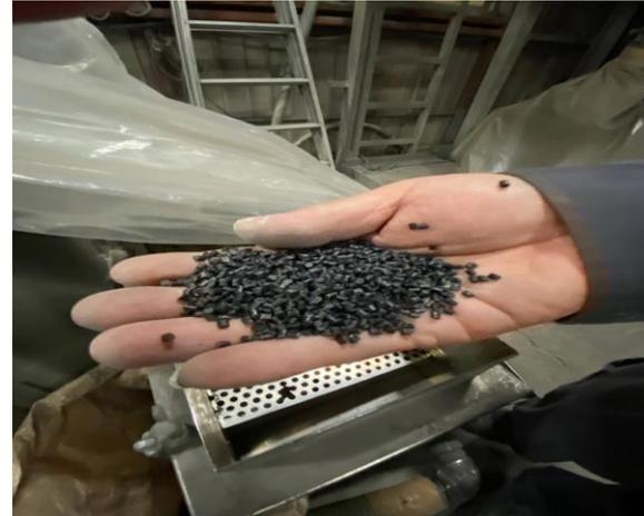
溶解された樹脂をストランドに押し出し、細断して原料（ペレット）となります。
