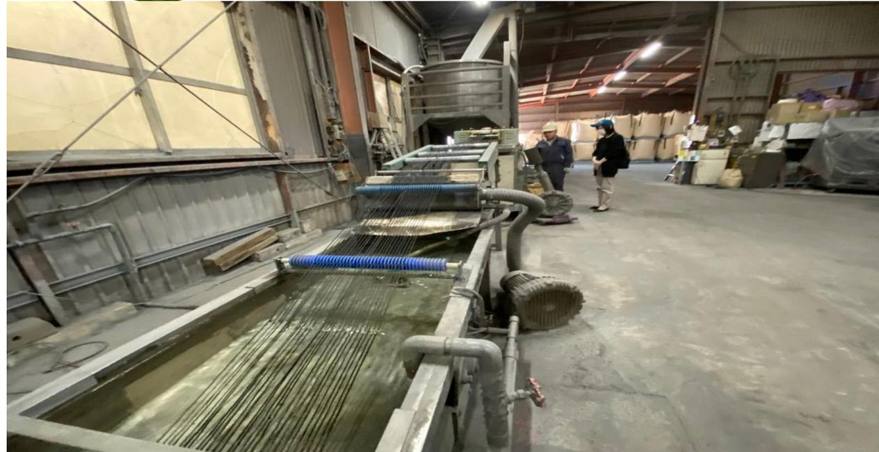
他のプラスチック素材を混合して強度を補強し、ペレット製造ラインに送り溶解します。
